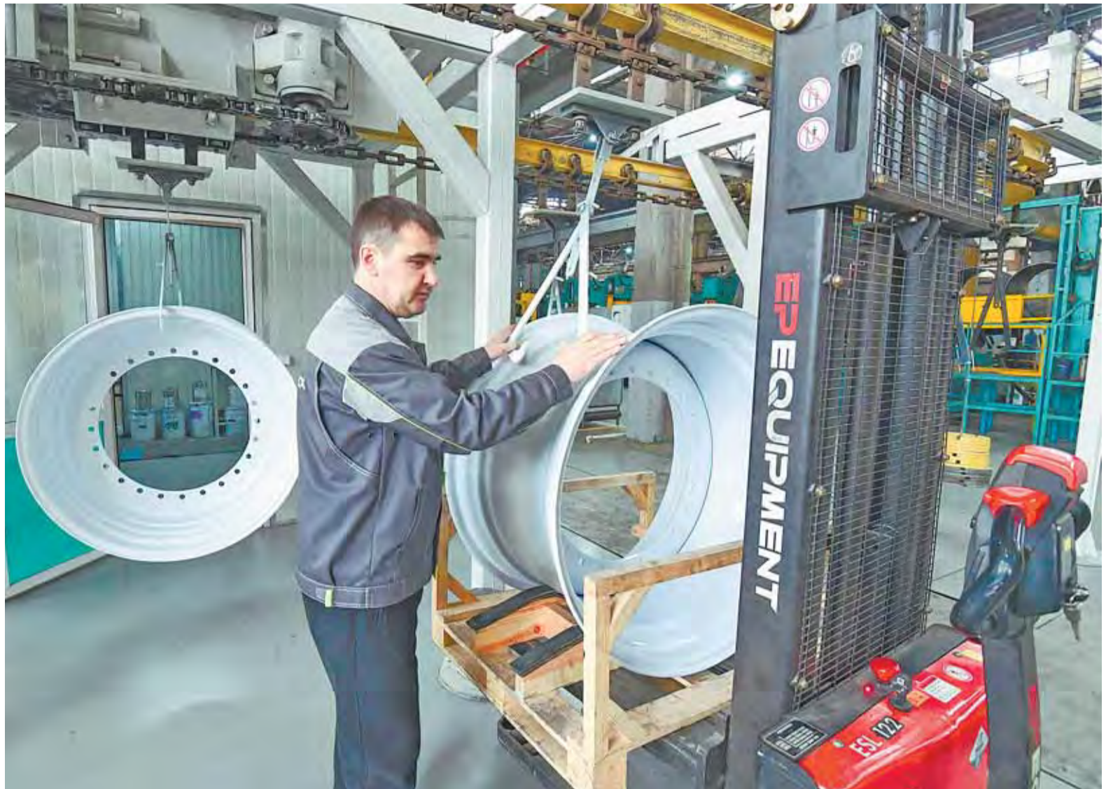
Производство дисков включает в себя автоматизированный комплекс лазерной резки, линии по изготовлению ребра и обода, а также роботизированные линии катафореза и покраски готовых изделий.
