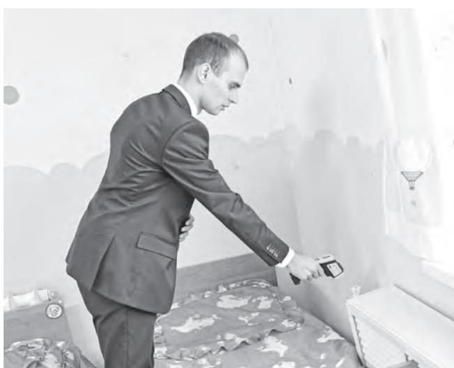
Температуру радиатора измеряют с помощью пирометра.
