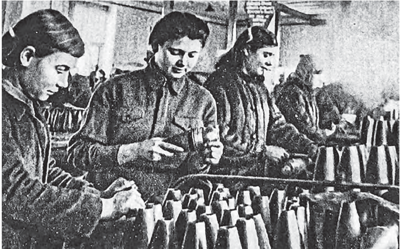
Барнаульский вагоноремонтный завод. Цех обработки заготовок для снарядов. 1940-е гг.
