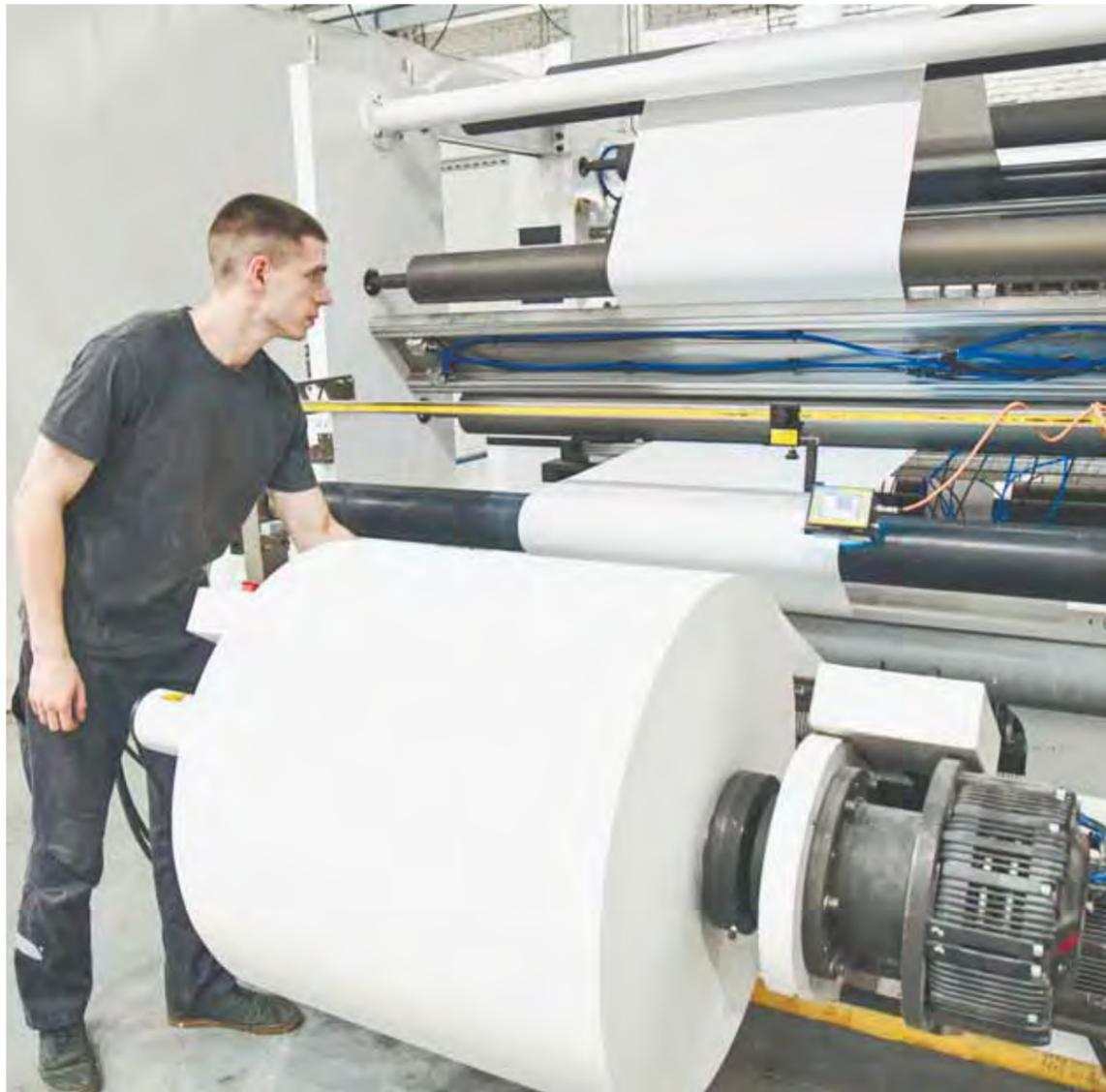
Бобинорезательный станок позволил оптимизировать работу типографии.
