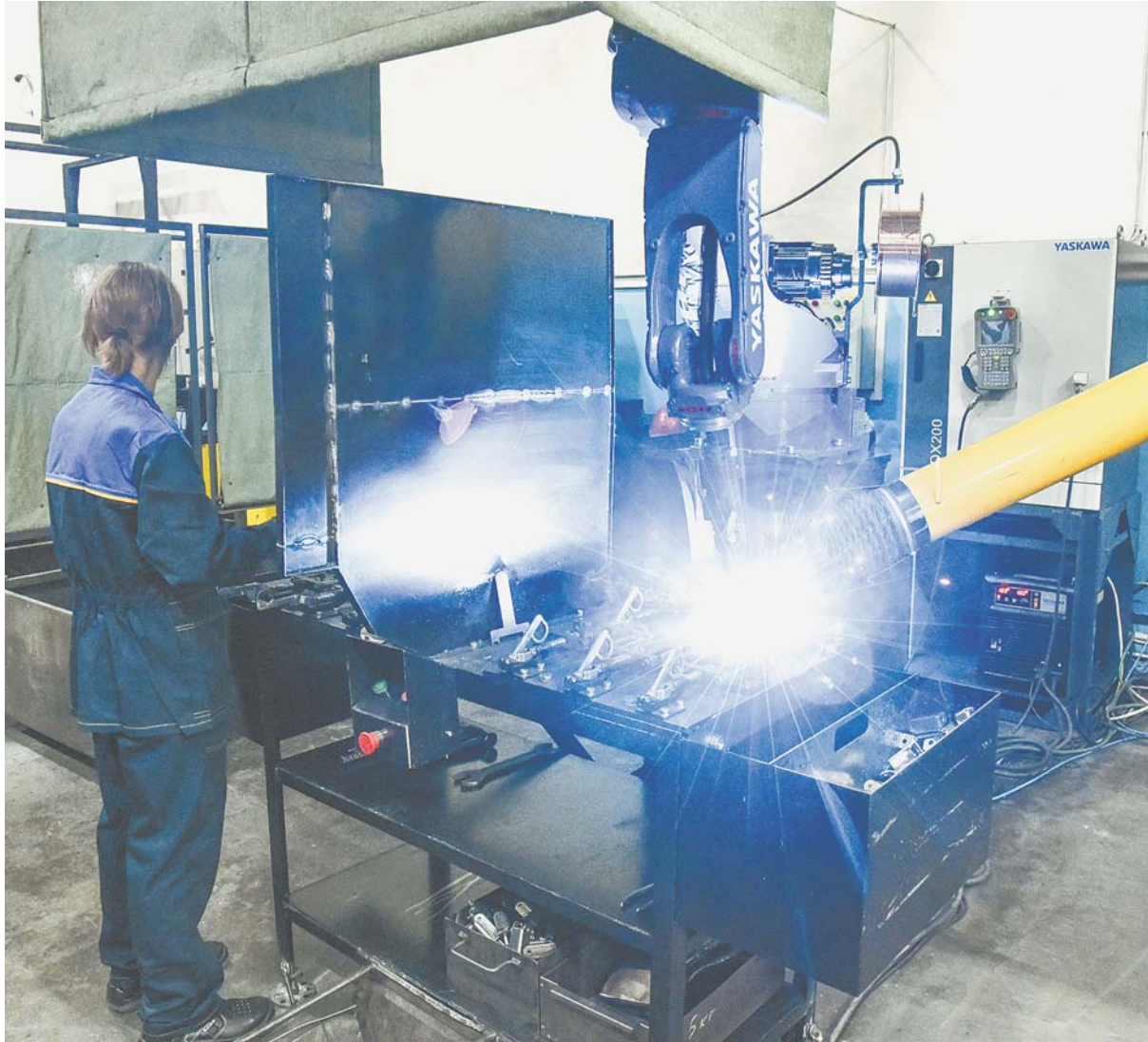
Роботизированный комплекс заменяет пять сварщиков, специальный экран защищает оператора от вредного воздействия.
