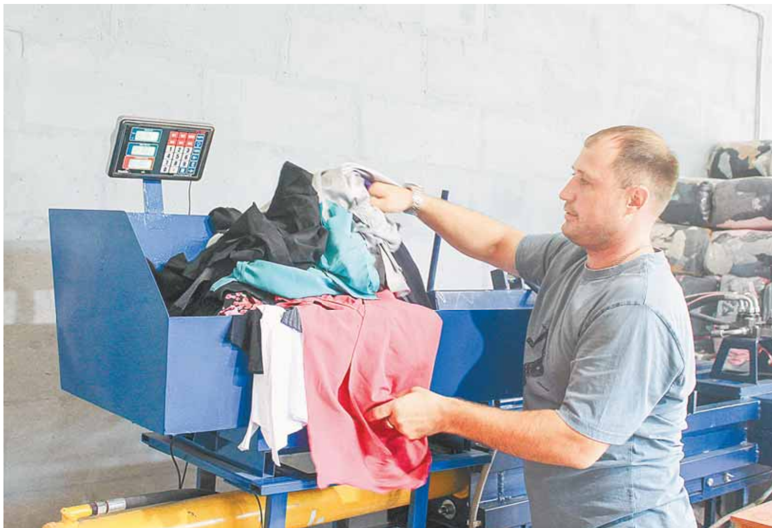
Нарезанный текстиль загружают в пресс — благодаря ему получаются аккуратные брикеты, удобные для транспортировки.
